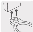
Para fijar el tanque del W.C. a la base
